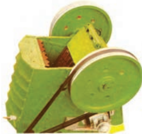
شکل ۱-۳- یک سنگ شکن فکی
